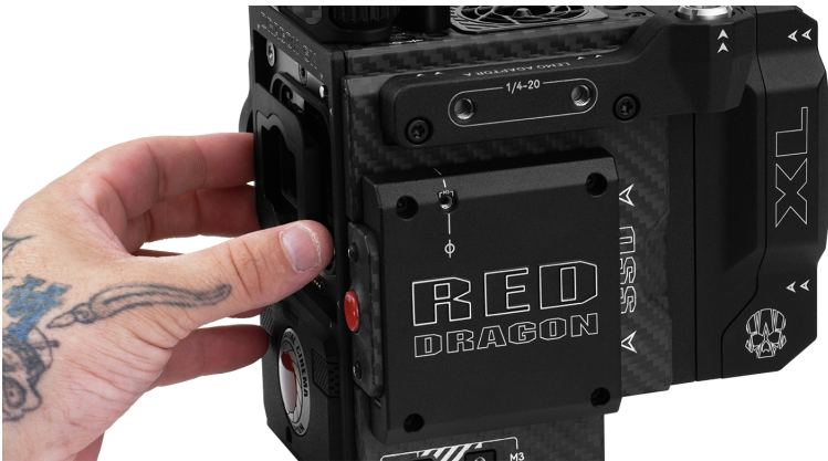
Figure: 安装新 OLPF 模块
