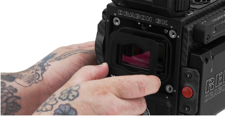
Figure: 取下 OLPF 模块
